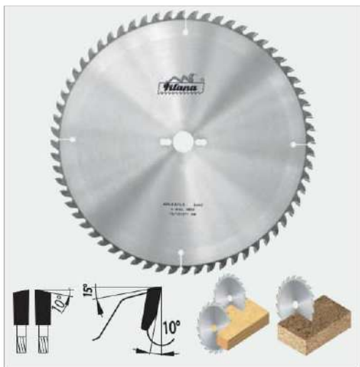
Pozdĺžne a priečne rezanie masívu, preglejky, bidosky, termoplastov a aglomerátov.
