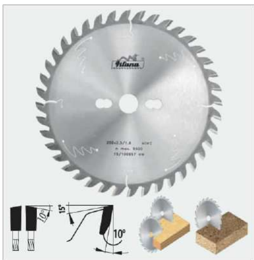
Priečne a pozdĺžne rezanie masívu, preglejky, bidosky a aglomerovaných materiálov.
