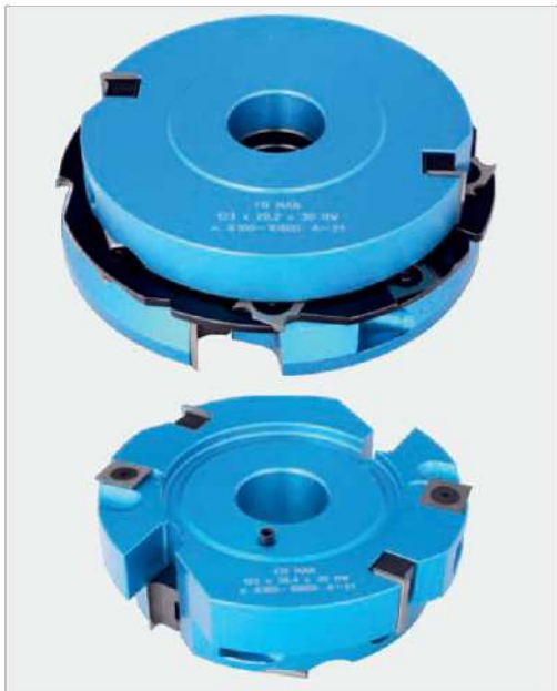
Sada pozostávajúca zo 4 nástrojov, kombináciou ktorých je možné dosiahnuť 3 typy profilov. Nástroje sú určené pre spodné frézovačky a sú vhodné aj pre ručný posuv.
